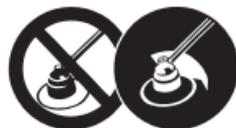
Odbačeni predmeti mogu izazvati teške povrede. Radite samo sa ispravno montiranim oklopom za motornu kosu ili za slobodni sekač i sa glavom za košenje. Držite rastojanje od najmanje 15 m (50 ft.) u odnosu na prisutne osobe.
