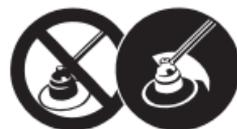
Sussiste il rischio di gravi lesioni per via degli oggetti scagliati. Lavorare soltanto con la protezione montata per il decespugliatore e la testa falciante. Mantenere la distanza minima di 15 m (50 ft.) dalle persone circostanti.
