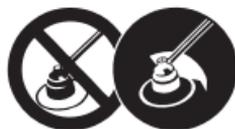
Αντικείμενα που εκσφενδονίζονται μπορούν να προκαλέσουν βαρείς τραυματισμούς. Χρησιμοποιείτε πάντα τον κατάλληλο, σωστά τοποθετημένο προφυλακτήρα για το χορτοκοπτικό ή κοπτικό μηχανήμα και την κεφαλή κοπής. Τηρείτε ελάχιστη απόσταση 15 μέτρων από άλλα άτομα.
