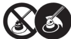
Los objetos pueden salir lanzados por el accesorio y pueden rebotar en cualquier sentido. Para reducir el riesgo de lesiones, nunca utilice una motoguadaña sin que tenga configurado e instalado debidamente el deflector. Mantenga a las demás personas a no menos de 15 m (50 pies) de distancia.
