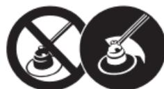
Etrafa fırlatılan cisimler ağır yaralanmalara sebep olabilir. Sadece motorlu tırpan veya ağır hizmet tipi tırpanın koruması ve kesici başlığı monte edilmiş durumda çalışın. Çevrede bulunan kişiler ile aranızda en az 15 m (50 ft.) mesafe bırakarak çalışın.
