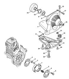
Муфта, Корпус вентилятора
