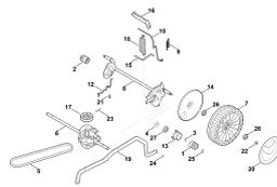
Задняя ось, регулировка
