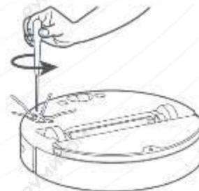
Переверните устройство и открутите болт крепления боковой щетки. Снимите и очистите щетку, после чего установите ее обратно.
