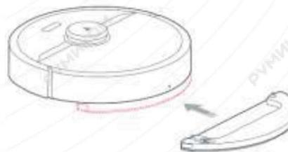
Установите модуль для влажной уборки. Выровняйте его, а затем задвиньте его внутрь, пока не услышите щелчок.
