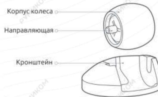
Переверните робот с снимите направляющее колесо.
