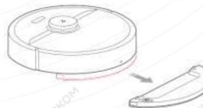
Когда цикл очистки завершен и робот-пылесос вернулся на зарядную док-станцию, нажмите защелки на любой стороне модуля для мытья полов и потяните назад, чтобы снять его.
