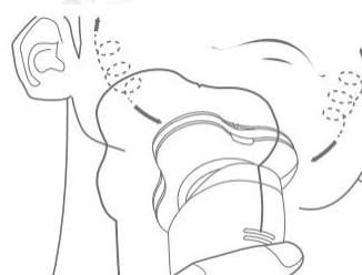
При ненадлежащей эксплуатации изделия можно повредить кожух лезвия и бритвенную головку. Перед каждым использованием проверяйте целостность кожуха и бритвенной головки. При обнаружении повреждений не используйте устройство.
