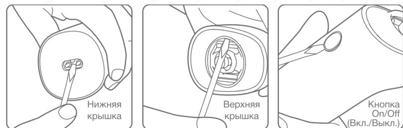
2. При помощи крестообразной отвертки отвинтите винты, расположенные в нижней части электрической бритвы, после чего извлеките через отверстие внутренний блок.
