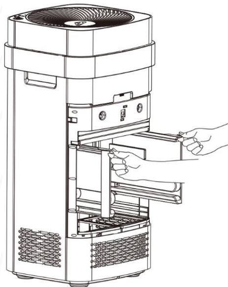
1. Отключите источник питания, откройте заднюю крышку и извлеките фильтрующие компоненты: ионизационную рамку, отводящий электрод, фильтр крупных частиц, а также защитные кожухи, как показано на рисунке.
