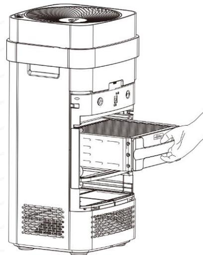
1. Для очистки отключите питание, откройте заднюю крышку и извлеките отводящий электрод.
