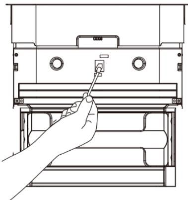
Очиститель воздуха Airdog имеет встроенный датчик качества воздуха. Чтобы сохранить точность показаний очищайте датчик каждые 3-6 месяцев с помощью сухой ткани или с помощью спиртовых протирочных тампонов.
