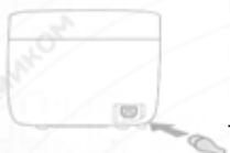
Подключите кабель питания к порту на задней стороне устройства, после чего вставьте вилку в розетку с переменным током.
