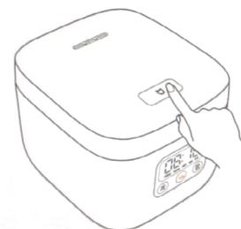
Нажмите на кнопку, чтобы открыть крышку. Примечание: в случае, если необходимо извлечь внутренний котел, следует полностью раскрыть крышку. При извлечении котла следует соблюдать осторожность во избежание повреждения внутренней крышки.
