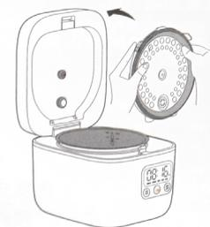
Вставьте внутреннюю крышку в предназначенное для нее место со стороны защелки и слегка надавите.
