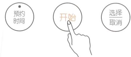
Нажмите на кнопку "Пуск" (开始), чтобы перевести устройство в режим приготовления.
