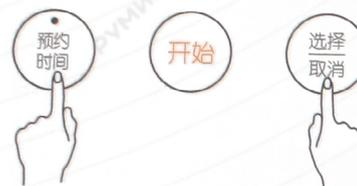
Зажмите кнопки “Таймер/Время” (预约时间) и “Выбор/Отмена” (选择取消), чтобы сбросить Wi-Fi, при этом на дисплее будут мигать индикаторы. После сброса подключения будет мигать индикатор Wi-Fi, а устройство перейдет в режим ожидания подключения.
