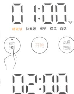
1) После выбора режима приготовления (Например, «Лучшая варка» (精煮饭)), нажмите на кнопку «Таймер/Время» (预约时间), чтобы установить время завершения приготовления.
