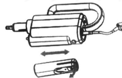
Снимите крышку резервуара, наполните его водой, а затем плотно закройте крышку и установите резервуар на основное устройство.
