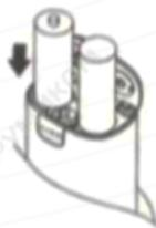
2. Соблюдая полярность, указанную внутри отсека, установите батарейки;
