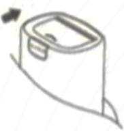
1. Нажмите на "^" и сдвиньте крышку отсека для батареек в направлении, указанном стрелкой;
