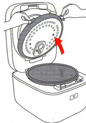
Откройте защелку, вытащите уплотнительную прокладку. Изъяв клапан выпуска пара, потяните защелку в сторону, откройте клапан, а затем вытащите уплотнительную прокладку.
