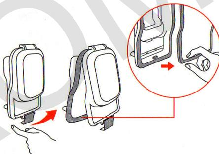
2. Точно наведите клапан выпуска пара на отверстие выхода пара, после чего, слегка придавливая, медленно вставьте его в место установки.
