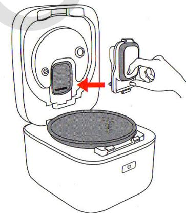
4. Вставьте защитную поверхность вдоль фиксирующей пластины с правой стороны.
