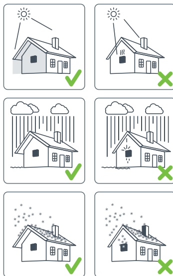
Рисунок 3.4.1 Правила расположения инвертора на фасаде здания
