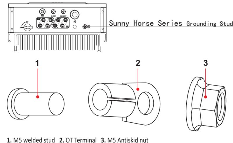
1. M5 welded stud 2. OT Terminal 3. M5 Antiskid nut
