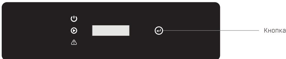
В качестве интерфейса «человек – компьютер» используется жидкокристаллическая панель со светодиодными индикаторами, кнопки и жидкокристаллический дисплей на передней панели инвертора.
