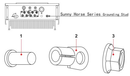
1. M5 welded stud 2. OT Terminal 3. M5 Antiskid nut
