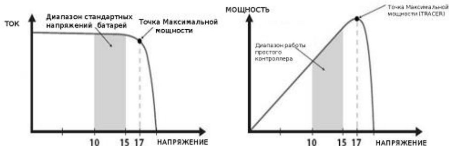
Рис.4. Зависимость силы тока от напряжения для систем с 12-вольтovým номиналом (I-V)
