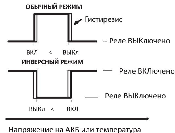
Рисунок 11. Режимы работы Реле
