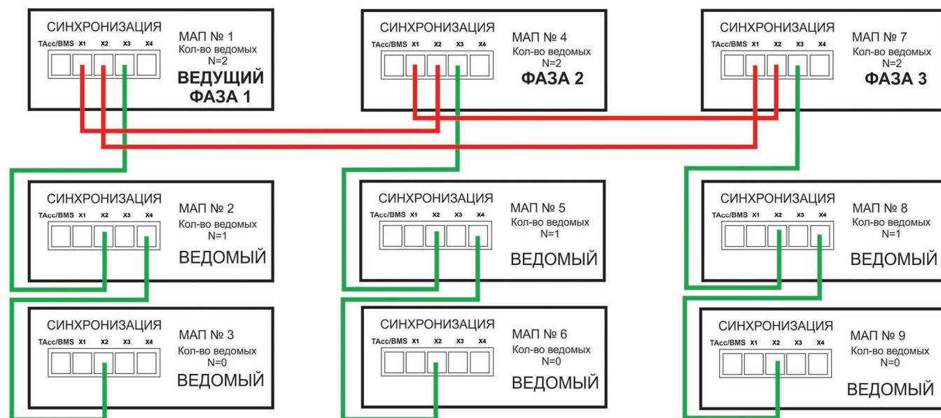
Рисунок 9. Схема синхронизации в трехфазной сети, пример на 9 приборов
