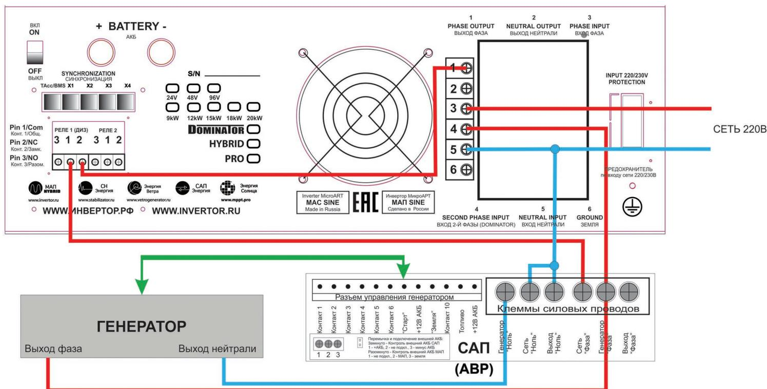
Рисунок 15. Пример подключения Бензо/Газо/Дизель генератора на 2-й вход МАП DOMINATOR с помощью САП или АВР
