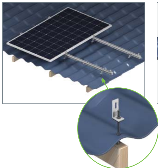
Рисунок 3.3.3 Крепежные элементы к металлочерепице или мягкой кровле
