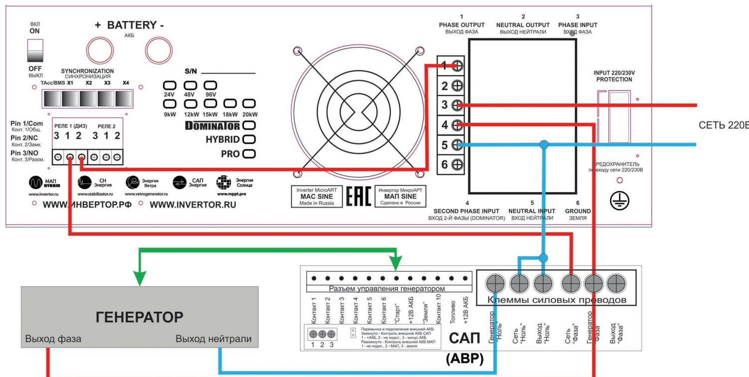
Рисунок 15. Пример подключения Бензо/Газо/Дизель генератора на 2-й вход MAP DOMINATOR с помощью САП или АВР
