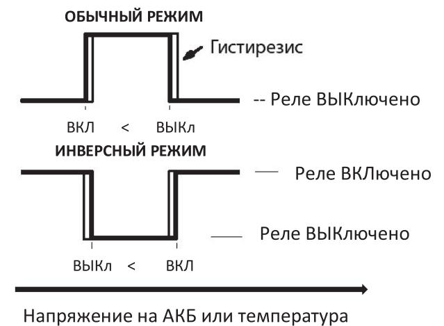
Рисунок 11. Режимы работы Реле
