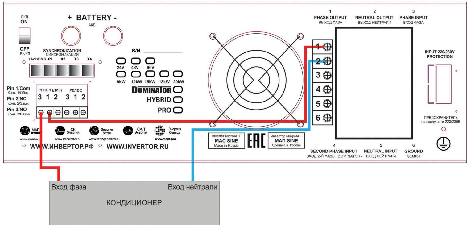
Рисунок 12. Пример подключения нагрузки через дополнительные Реле
