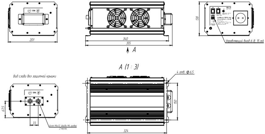
Рисунок 1-е. Внешний вид преобразователей СибВольт 1548 Li-ion
