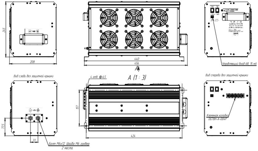
Рисунок 1-г. Внешний вид преобразователей СибВольт 6048 Li-ion
