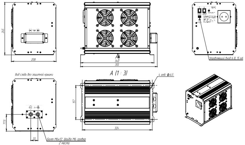
Рисунок 1-в. Внешний вид преобразователей СибВольт 3048 Li-ion, 4048Li-ion
