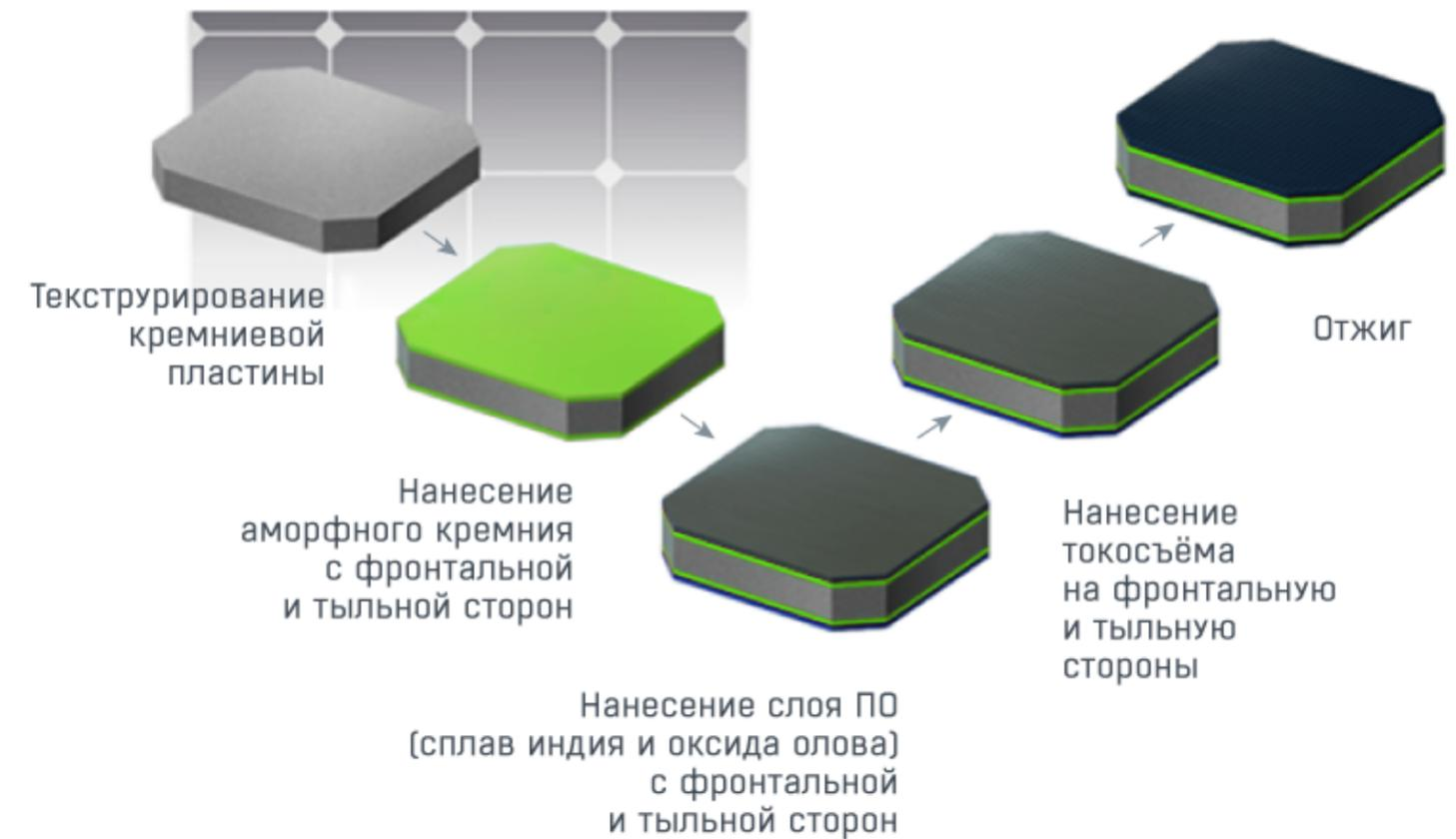
**Технология НТ: c-Si основа + тонкоплёночная технология =
