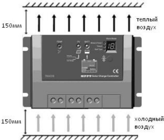
Рис.2. Установка контроллера
