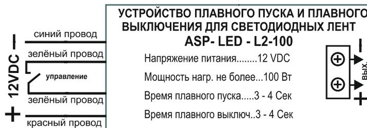
**ВНИМАНИЕ!** При включении внешнего контакта (выключателя) происходит плавный пуск.
