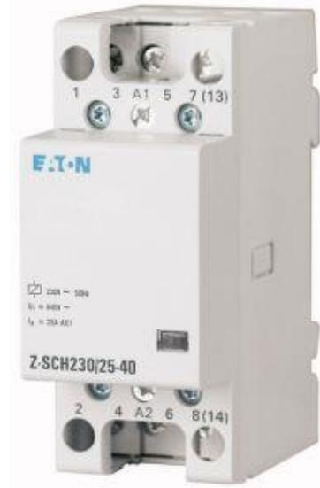
Установить 4 перемычки на контакты 1-3 и 5-7, 2-4 и 6-8 как показано на рисунке. Подключить выводы катушки A1 и A2 к выходу реле напряжения ASP.
