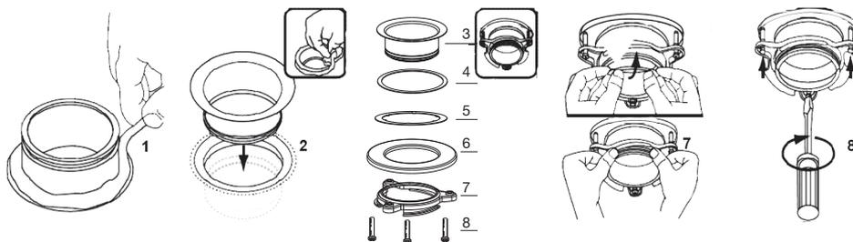
1. Обработать фланец раковины герметиком
