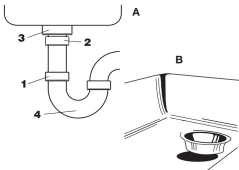
1. Ослабить гайку (1) на фильтре (4) с помощью гаечного ключа (**см. А**)
