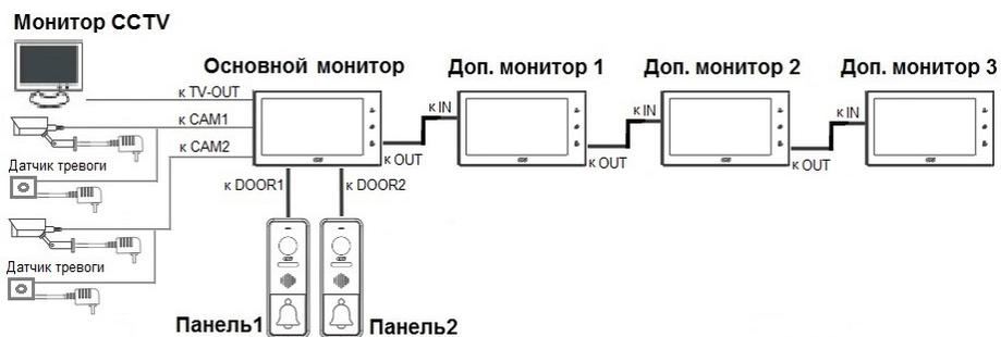
Вызывные панели подключаются только к основному монитору.
