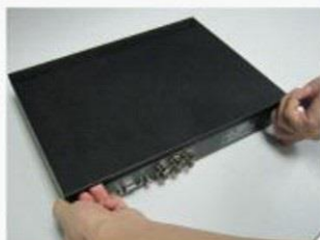
② Аккуратно снимите крышку устройства
