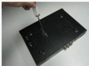
⑤ Переверните устройство, зафиксируйте жёсткий диск 4 винтами, придерживая его
