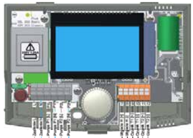
Рис. 06 Внутренняя часть регулятора с клеммами
