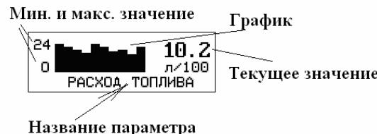
Нажатие на кнопку «Ввод» приводит к переходу на отображения параметра в графической форме, при нажатии на кнопку «Выход» переводит к отображению в цифровой форме.
