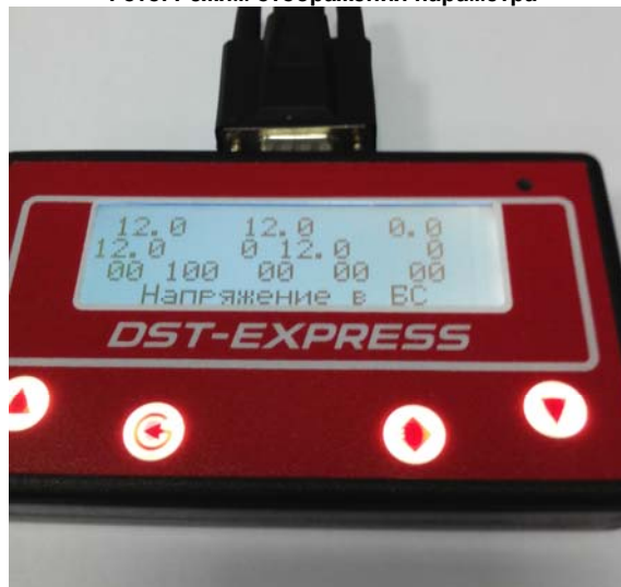
Фото. Режим отображения минимального и максимального значения параметра
