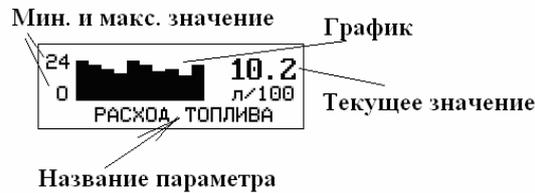
Нажатие на кнопку «Ввод»  $\nabla$ , приводит к переходу на отображения параметра в графической форме, при нажатие на кнопку «Выход»  $\wedge$  переводит к отображению в цифровой форме.
