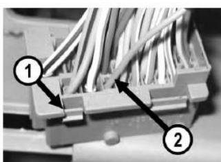
Рис.4 Подключение ДУТ
