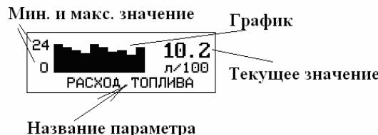
Нажатие на кнопку «Ввод» приводит к переходу на отображения параметра в графической форме, при нажатие на кнопку «Выход» переводит к отображению в цифровой форме.
