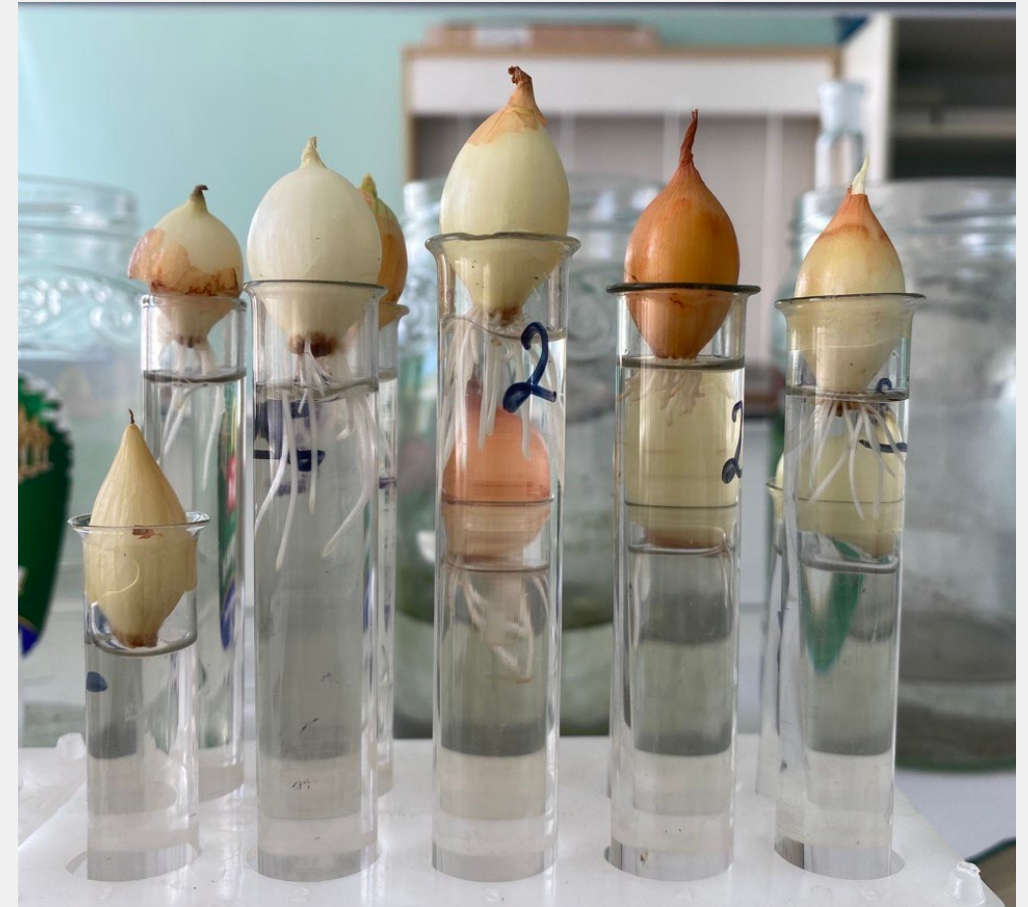
Определение токсичности талой воды методом allium-еуе
