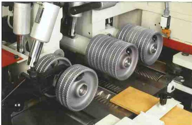
Schweres Einzugssystem mit angetriebenen Vorschubwalzen und 200 mm breiten, angetriebenen Tischrollen.
