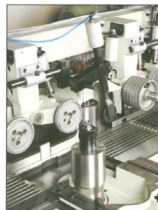
Nuten-Führsystem für gerade Fugekanten ergibt verleimfähige Werkstücke. Auch kurze, ungekappte Werkstücke werden parallel, auch verzogene genau abgerichtet, auch konische und geschwungene exakt dickengehobelt.
