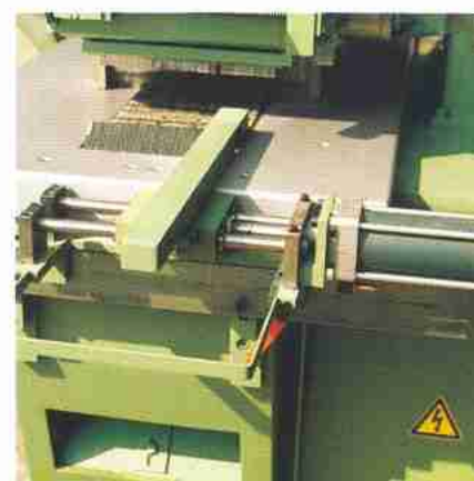
Schnellverstellungsanschlag pneumatisch Pneumatic quick adjustment fence Guide pneumatique pour réglage rapide
