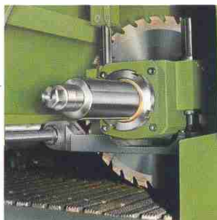
Sägeblattverstellung für verleimfähigen Schnitt und mitlaufendem Stahl- druck-rechen Saw blade adjustment for direct glue cut with movable pressure shoe Réglage de la lame pour coupe encol- lable sur le trait de scie et rateau presseur en acier mobile
