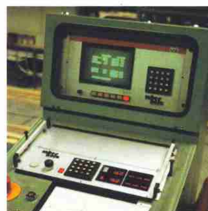
Sägeblattverstellung, elektronisch, mit rechnergestützter Optimierung und Bildschirmanzeige Electronic sawblade adjustment with computer added optimization and screen display Réglage électronique de la lame avec optimisation à commande numérique et écran de visualisation
