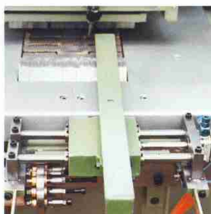
Pneumatisch gesteuerter Anschlag mit 5 wählbaren und einzeln einstellbaren Positionen Pneumatically controlled fence with 5 selectable positions, separately adjustable Guide pneumatique à 5 positions pré- sélectionnées, réglables individuellement
