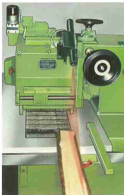
Richtlichtgerät, mit Laserstrahl, für feste und bewegliche Sägeblätter
