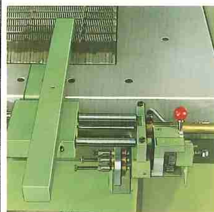
Pneumatischer Schnellverstellungsanschlag mit 5 Positionen
