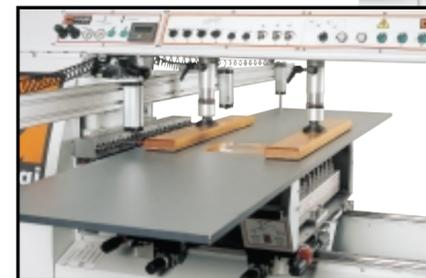
▲ Deux presseurs pneumatiques tournants de 0° à 90° avec plaque en bois 750 x 106 x 30 mm. Pour une parfaite distribution de la précision, ces presseurs brevetés contre les accidents du travail permettant l'appui immédiat sur les panneaux de n'importe quelle épaisseur sans aucun besoin de réglage.
