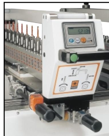
◀ Lecteur électronique à batterie avec réglage micrométrique de la position de la tête et compteur digital (avec précision décimale) pour le réglage de la profondeur du perçage
