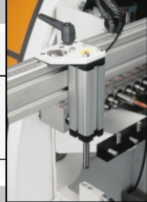
Système pour ramasser la poussière et aspiration avec liaison directe à l'équipement de 80 mm.
