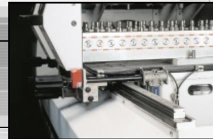
▲ Mouvement transversal des têtes verticales avec glissement sur guides prismatiques et patin à roulements à billes et raclage poussier.
