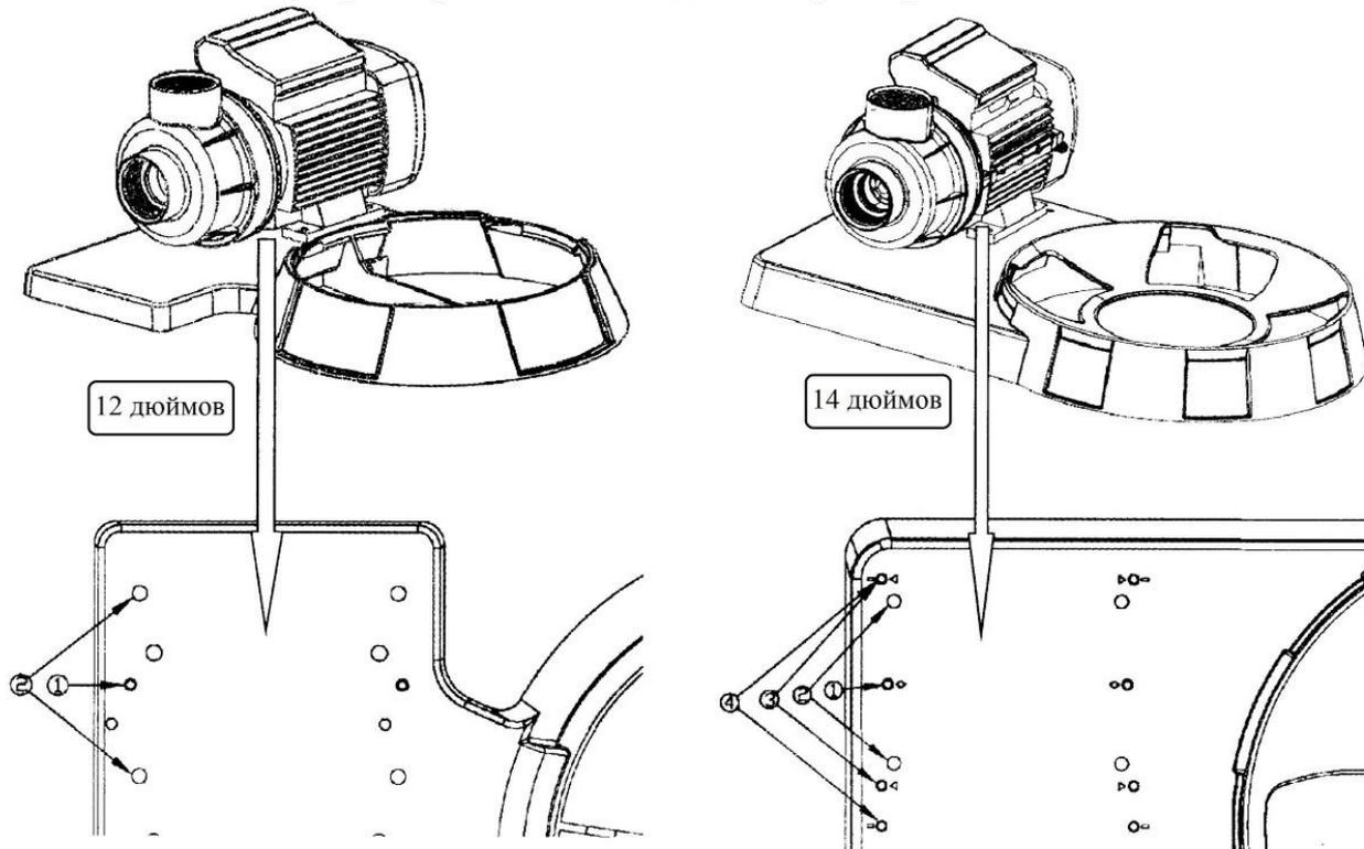
Монтажные отверстия для 12 дюймового песочного фильтра:
