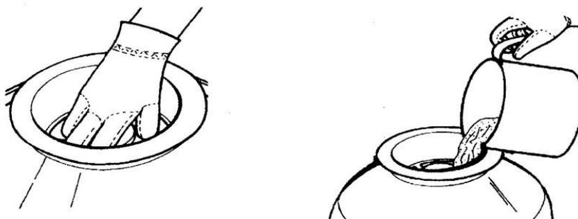
5. Уберите шаблон, и убедитесь, в том, что горловина бака осталась чистой. Наденьте на клапан уплотнительное кольцо и при помощи зажимного фланца зафиксируйте на баке фильтра (порт клапана с меткой "Насос" должен быть повернут к выходному порту насоса).
