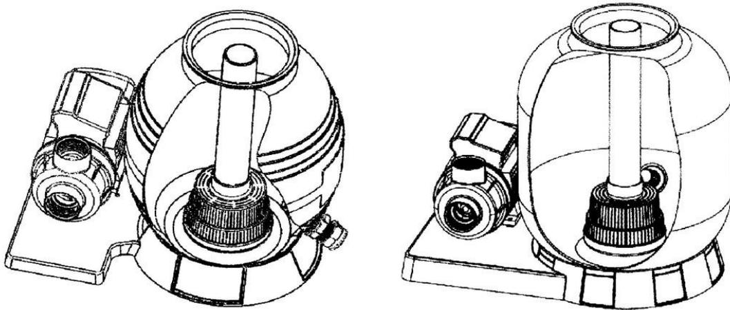
4. Вставьте коллектор внутрь бака фильтра, как это показано на рисунке выше. Затем поместите пластиковый шаблон на горловину бака и засыпьте песок (в 12-дюймовый песочный фильтр необходимо засыпать 19 кг песка, в 14-дюймовый фильтр засыпается 27 кг песка).
