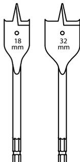
Сверло/пери по дереву на 18 мм (ввод провода), на 32 мм (вывод чистой воды)
