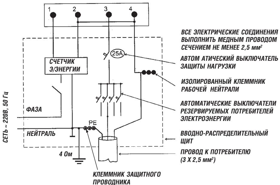
Корпус электроагрегата должен быть подключен отдельным медным проводником сечением не менее 4 мм<sup>2</sup> к контуру заземления.
