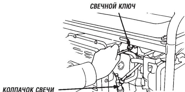
4. Произвести внешний осмотр свечи. В случае обнаружения трещин в изоляторе свечу следует заменить. Если свеча пригодна к дальнейшему использованию, ее нужно очистить проволочной щеткой.
