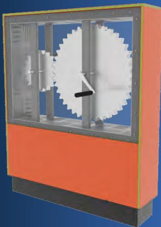
Стенд с двумя зубчатыми передачами с разными передаточными числами с рукоятками на обоих валах позволяет соревноваться «кто-кого» перекрутит.
