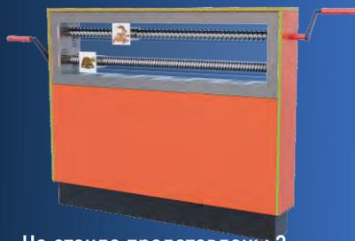
На стенде представлены 2 винтовые передачи винт-гайка с разным шагом резьбы.
