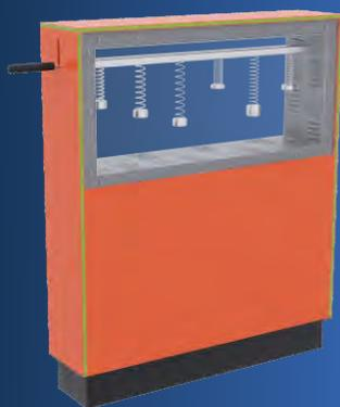
Представляет собой верхнюю балку, на которой подвешены разные грузы на пружинах различной жесткости. При толкании балки в вертикальном направлении грузы на пружинах начинают качаться с разной частотой и амплитудой.
