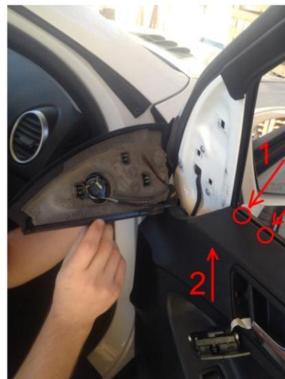
4. Вытащив заглушку с торца двери, откручиваем винт (действие №1) держащий личинку ручки, после чего снимаем личинку, потом отсоединяем ручку. Далее откручиваем под ручкой 2 винта (действие №2). Потом откручиваем замок с торца двери (действие №3).
