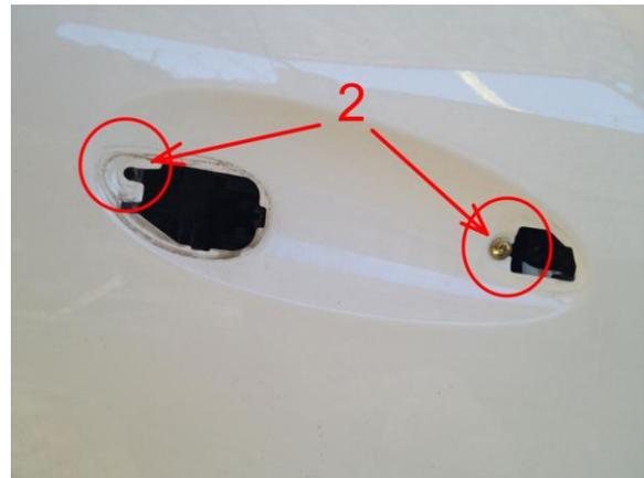
5. Откручиваем по периметру винты на металлической панели. После чего вынимаем панель вместе с замком из двери.
