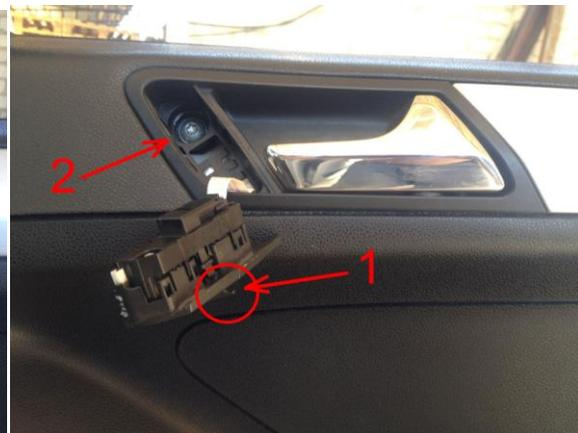
3. Отсоединяем внутреннюю карту двери плоским предметом (отвёртка, линейка) от щёлкнув по периметру клипсы. Далее поддеваем вверх, (действие № 1) верхнюю часть карты - бархотку отвёрткой , после чего отсоединяем карту (действие № 2), двигая её вверх.
