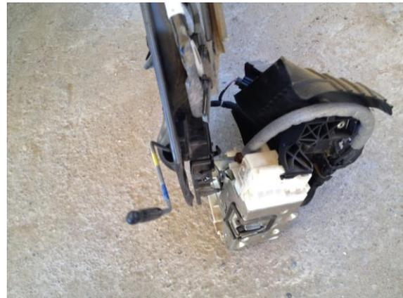
6. Заменяем сломанную пружинку, проверяем работоспособность (элемент механизма должен фиксироваться в крайних положениях пружинкой).
