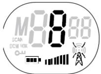
Приемник настроен на получение сигнала, когда он включен и не передает звук. При поступлении загорится знак получения.
