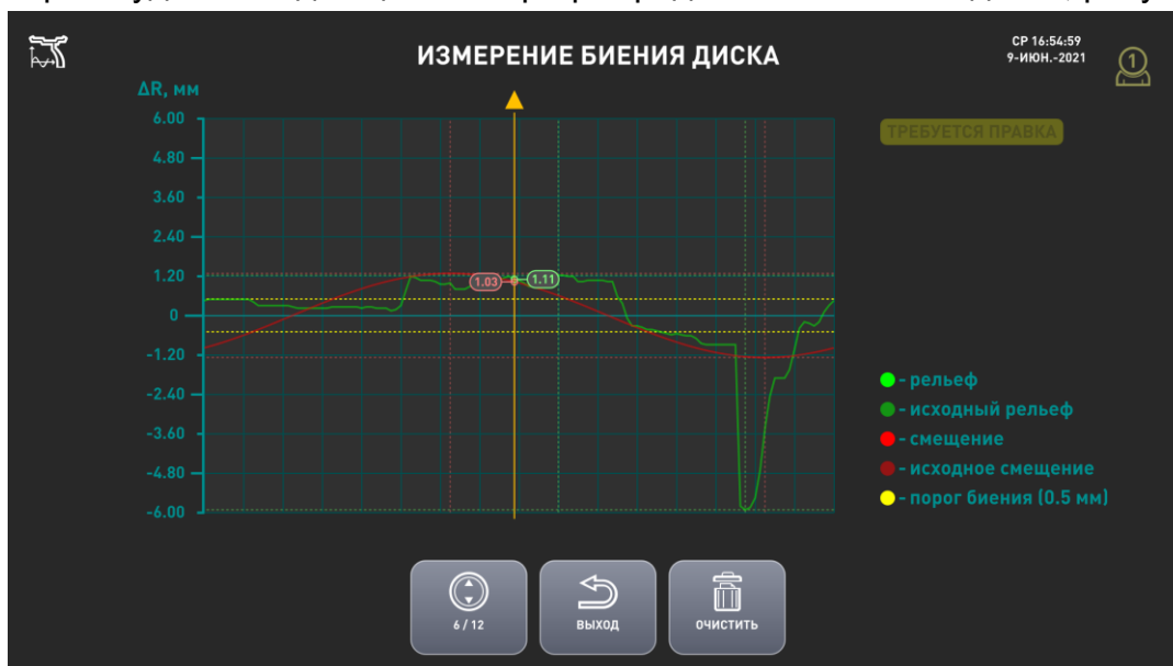
Рисунок 8.8 – Окно измерения биений диска
