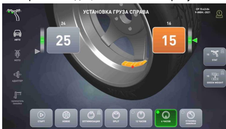
Рисунок 5.8 – Установка в «6 часов» справа
