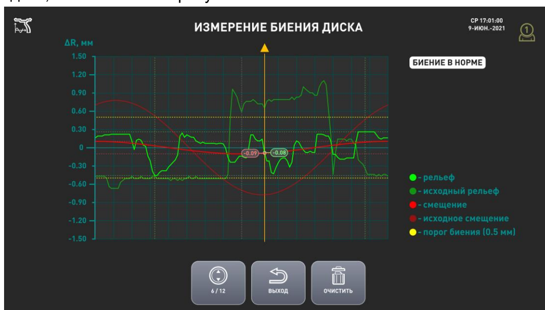
Рисунок 8.9 – Окно сравнения биений диска
