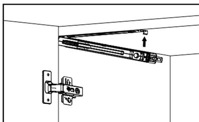
После установки механизма не забудьте закрыть защитную защелку
