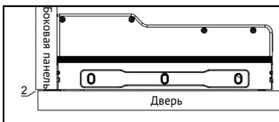
После регулировки толкателя закройте его силиконовой защитной крышкой
