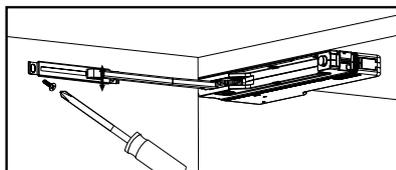
Защелкните рычаг на ответной части механизма
