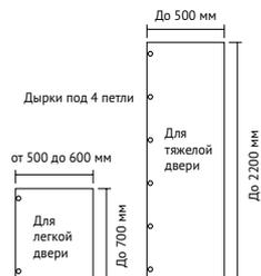
Схема установки механизма
