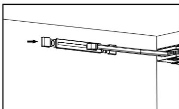
Откройте и закройте механизм несколько раз, чтобы убедиться, что он работает корректно. Длина растяжения спускового механизма может быть отрегулирована до нужной плавности хода или под конкретный дверной проем
