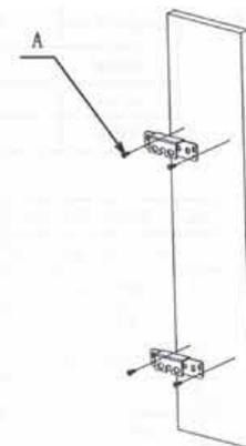
**5** Зафиксируйте корзину на передней двери с помощью винтов (C)(D), и отрегулируйте дверь: Внимание: Не затягивайте сильно винты (D) перед регулировкой, затяните винты только после финальной регулировки.
