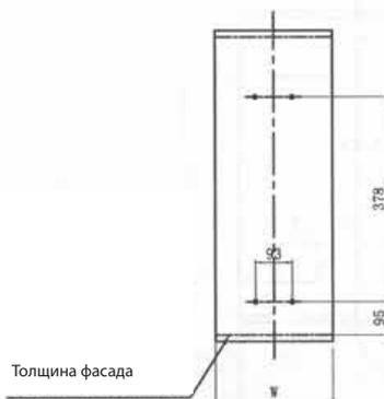
**4** Присоедините 2 фиксатора (E) к передней двери 4-мя саморезами (A)
