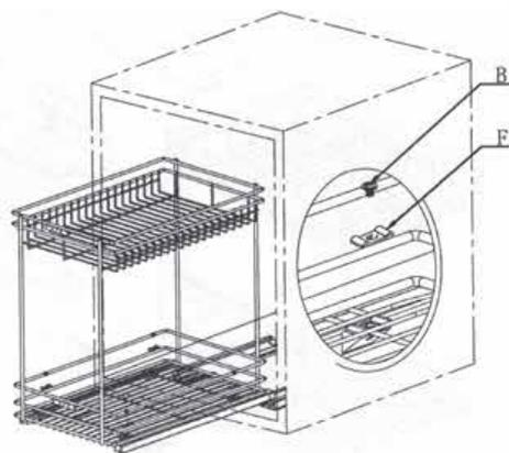
**3** Просверлите 4 отверстия диаметром 2.5 мм на передней двери, как показано на схеме внизу.
