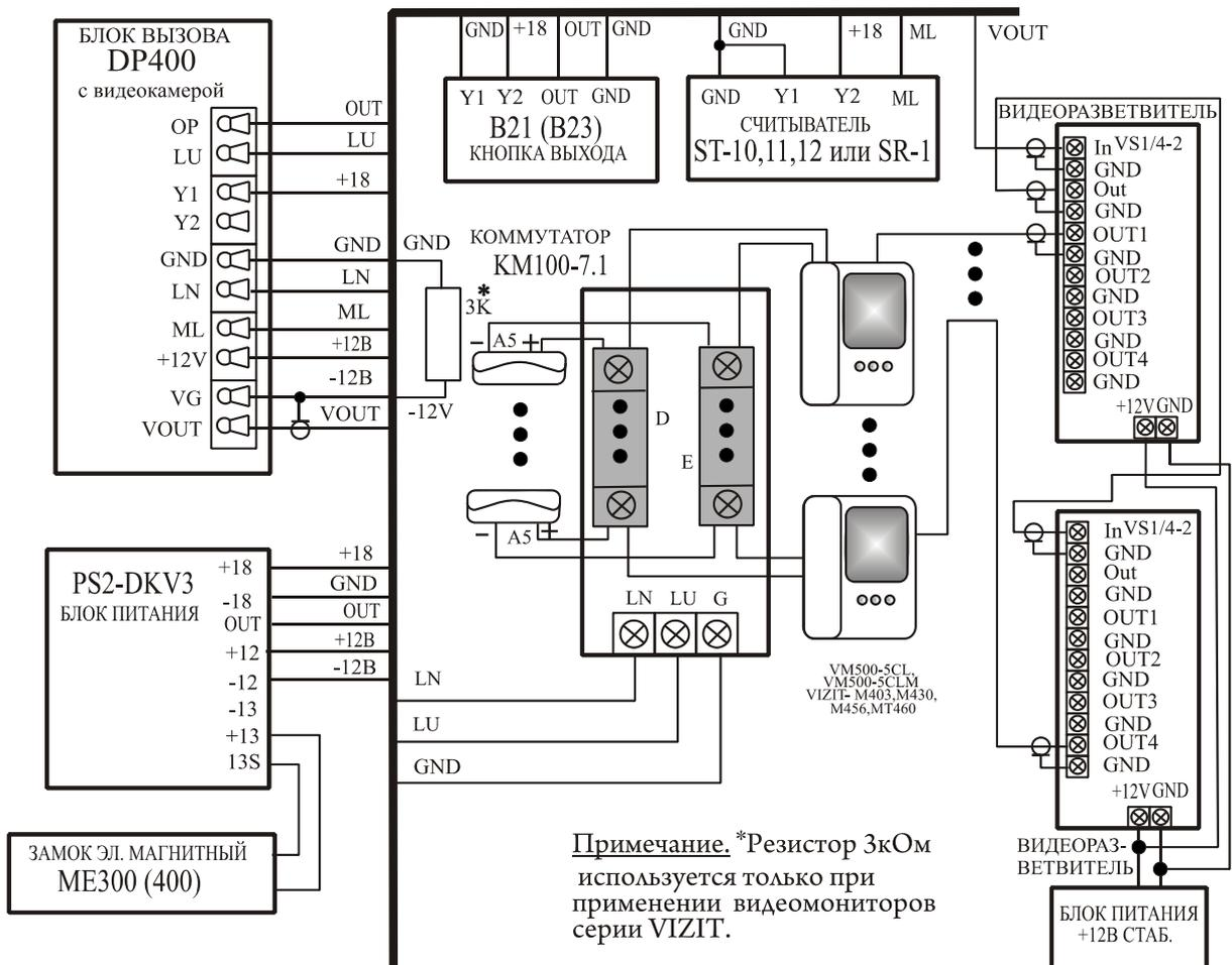
**Примечание.** \*Резистор 3кОм используется только при применении видеомониторов серии VIZIT.
