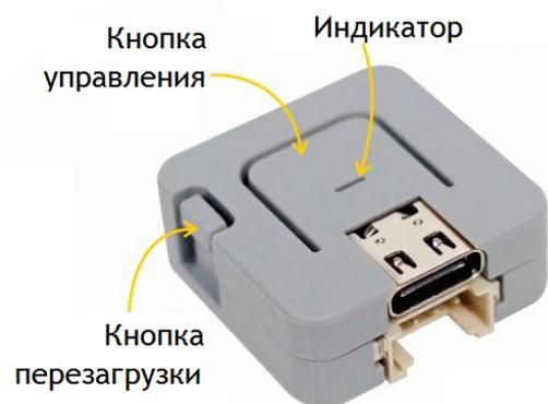
Представляет собой модуль, который подключается к USB порту. Управление происходит по беспроводному каналу Wi-Fi.
