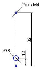
а) установка с помощью комплекта крепления КМ13 или 2-х винтов М4х16.
