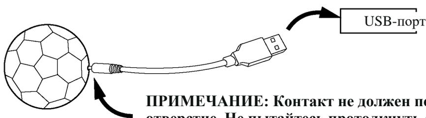
**ПРИМЕЧАНИЕ:** Контакт не должен полностью входить в отверстие. Не пытайтесь протолкнуть его после установки.
