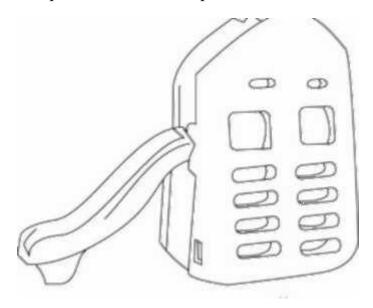
7. Поставьте горизонтально перекладину в разрез верхней части стены горки, надавите вниз и прочно закрепите. Болт и сальник должны проникнуть в отверстие горки, вбейте их, используя молоток.
