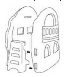
3. Поставьте стенки на расстоянии напротив друг друга и между ними вставьте платформу. Вставьте один конец платформы в отверстия
